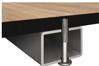
Изображение 40: рекомендуемое крепление для столешницы из компакт-плиты
