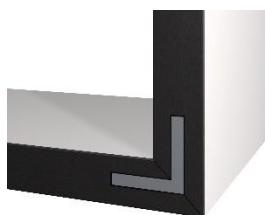
Изображение 12: угловое соединение шпонкой
