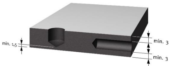
Изображение 5: минимально допустимые расстояния от отверстий до пласти плиты
