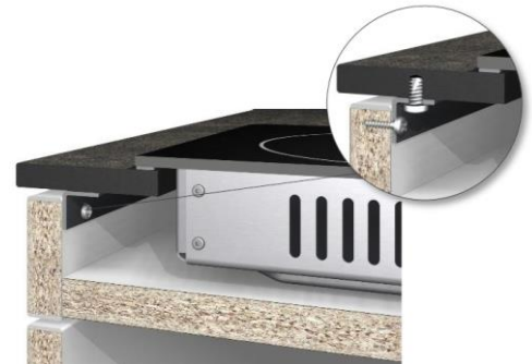
Изображение 51: стабилизация конструкции с помощью металлической планки
