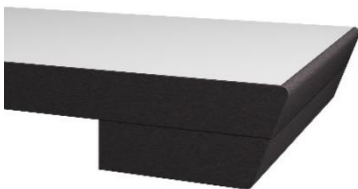
Изображение 15: увеличение толщины посредством приклеивания к пласти плиты элемента из плиты такой же толщины («ложный» край)
