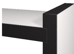
Изображение 9: соединение в шпунт
