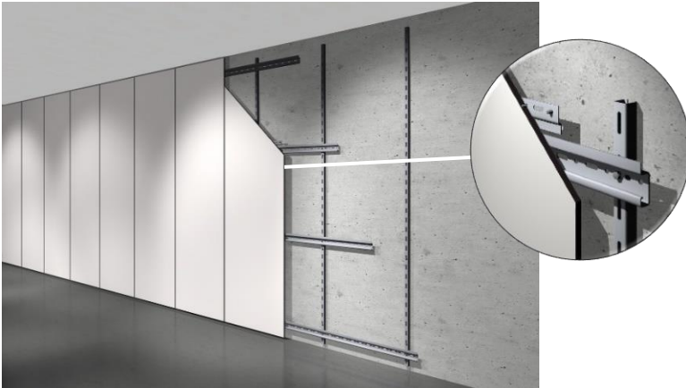
Изображение 26: скрытое крепление компакт-плит
