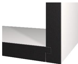
Изображение 10: соединение в шпунт / в четверть
