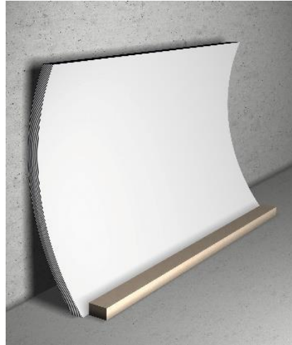
Изображение 3: неправильное хранение компакт-плит
